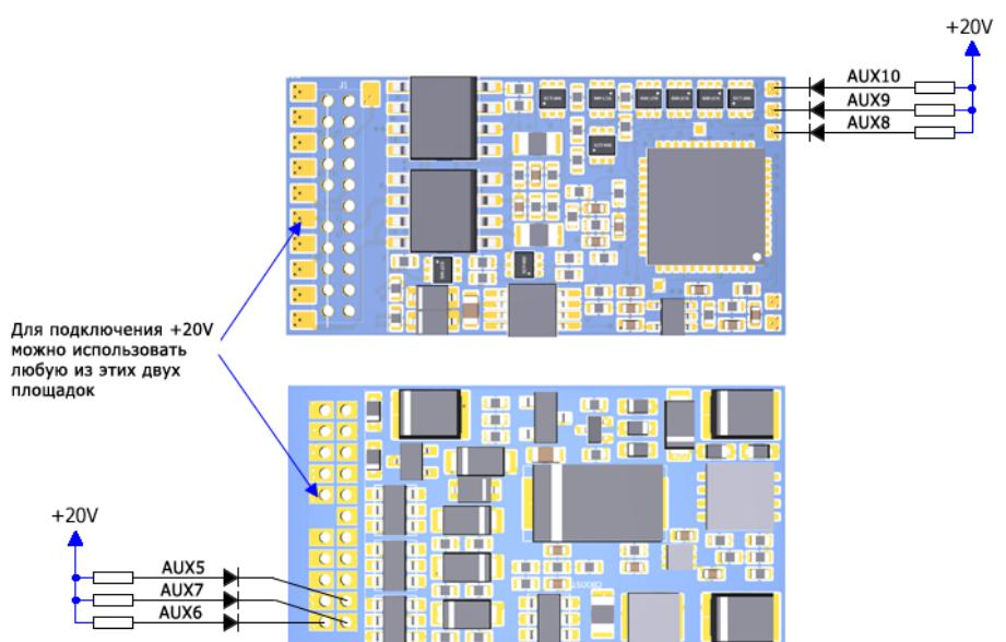
К декодеру версии SoundGT2.1 (P0) на эти выходы также можно подключать любые лампы, парогенераторы и некоторые модели сцепок.
