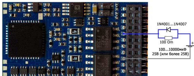
Схема подключения для платы 21MTC
