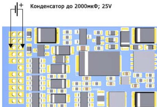
Декодер SoundGT2.1 имеет встроенный ограничитель тока и напряжения заряда конденсатора, поэтому конденсатор емкостью до 2000мкФ можно подключать напрямую к контактам «GND» и «Конденсатор +». При этом можно использовать конденсатор, рассчитанный на 16В. Даже если напряжение на рельсах выше 16В.
