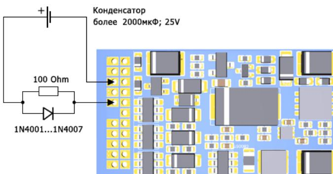
Если требуется подключить конденсатор емкостью более 2000мкФ, то необходимо добавить внешний ограничитель тока заряда. При этом **необходимо использовать конденсаторы с макс допустимым напряжением не менее 25В**
